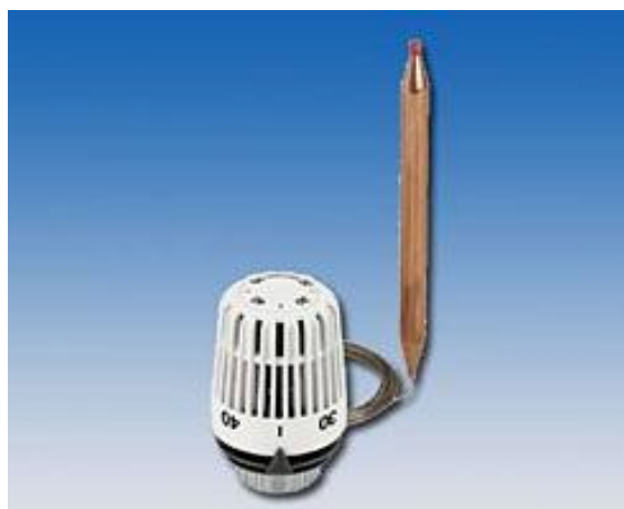
Рис.6 Термостатическая головка Heimeier с накладным датчиком, +20...+50С
