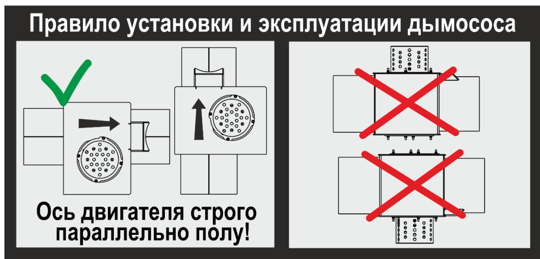
Рис. 8 Установка дымососа
