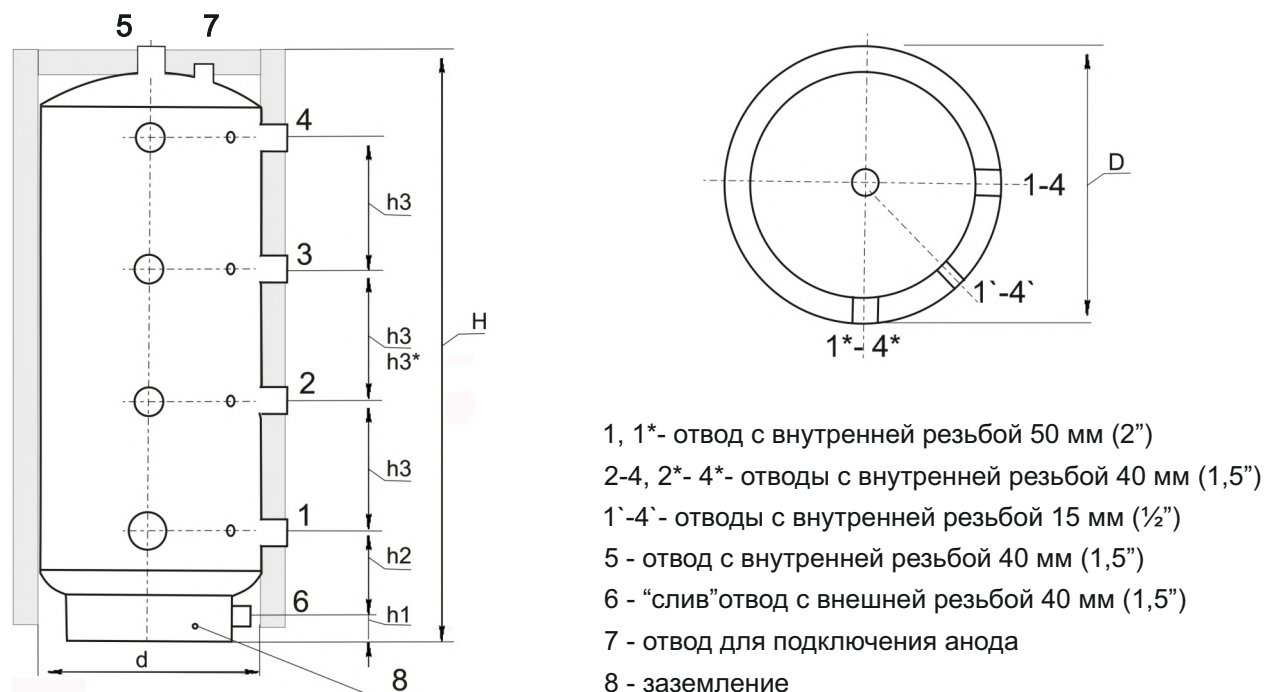
Рисунок 1. Схема подключения теплоаккумулятора серии ТА
