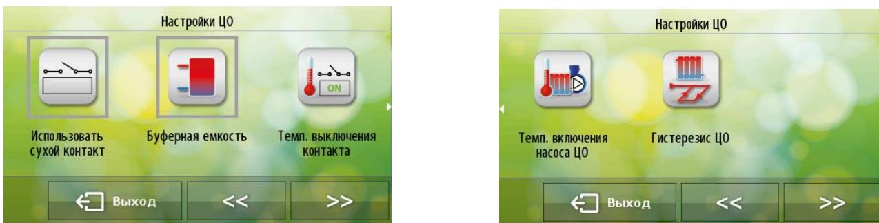
Регулятор имеет выход стыка без напряжения, задачей которого является размыкание (или замыкание) стыка, когда температура ЦО достигнет установленного пользователем значения. Диапазон настроек этого параметра это  $30 \div 75^{\circ}\text{C}$ .
