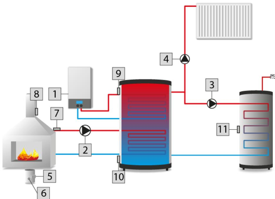
\*Наглядная схема - схема не заменит проекта системы ЦО. Она показывает возможность расширения контроллера. На вышеуказанной схеме отопительной системы не показаны отключающие и защищающие элементы для её правильного монтажа.
