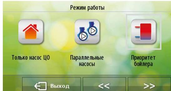
Функция приоритет ГВС заключается в том, что в первую очередь нагревается горячее водоснабжение, а потом вода в батареях.
