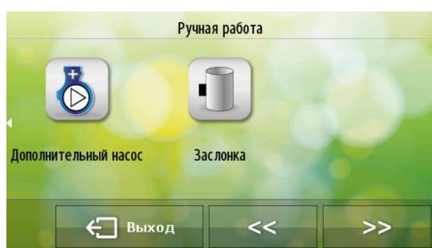
Дополнительно пользователь имеет возможность ручного управления работой дросселя, регулируя процентное значение открытия. Дроссель изменяет свое положение до заданного значения в течение двух секунд после ручного процентного изменения уровня открытия.
