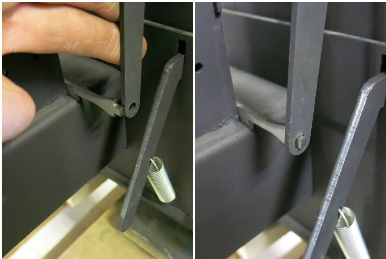
Рис. 25 - Установка тяг регулятора
