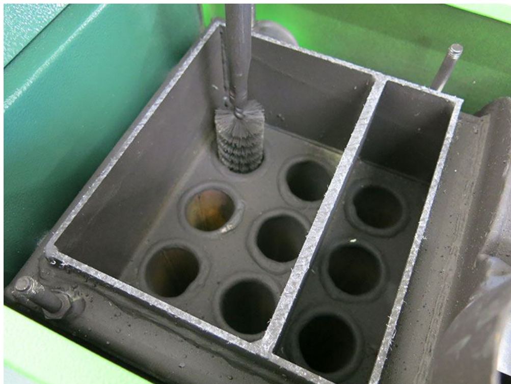
Рис. 36 - Чистка трубчатого теплообменника
