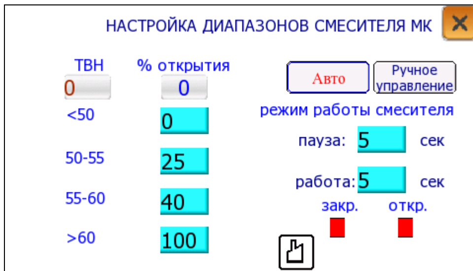
Рис. 18. Настройка диапазонов смесителя МК
