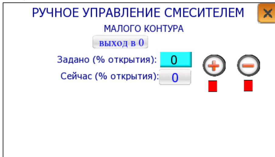
Рис. 19. Ручное управление смесителем малого контура
