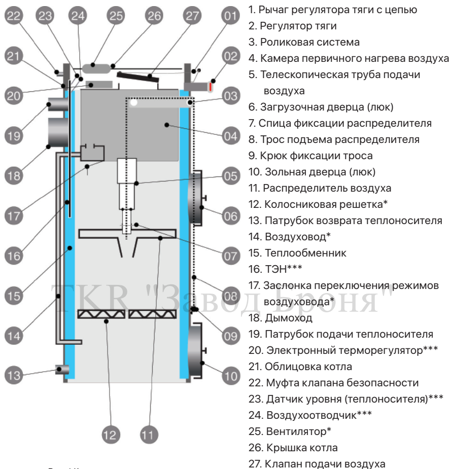
Рис. 1 Конструктивная схема котла
