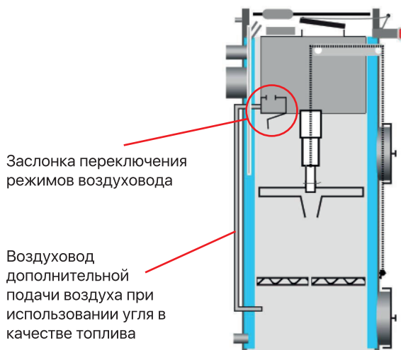
Рис. 1 Схема дополнительного воздуховода
