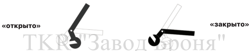
Рис. 24 Положение ручек дверец при работе запорного механизма
